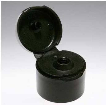
La chiusura flip top è costituita da un tappo con un corpo e un coperchio collegati da una linguetta. La cerniera permette di richiudere il coperchio sul corpo del tappo flip top. Il coperchio presenta una leggera sporgenza che crea un'area ancora più ampia per aprire il flip top. Una volta aperto, il liquido fluisce attraverso l'orifizio del tappo flip top.
